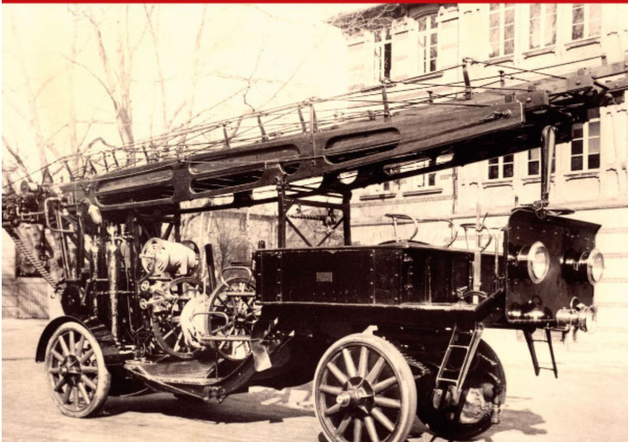
Die elektroautomobile Drehleiter der Feuerwehr Offenbach war 1903 ein absolutes »Hightech-Fahrzeug«
